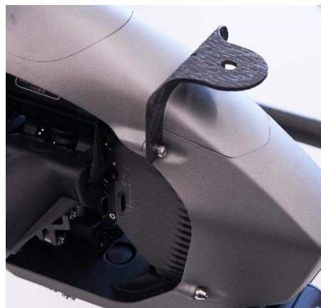
写真4 機体前に取り付けたアンテナ土台
