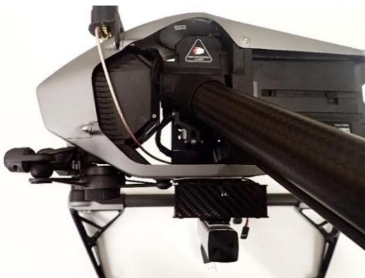
写真 6 アンテナケーブルの通し方
