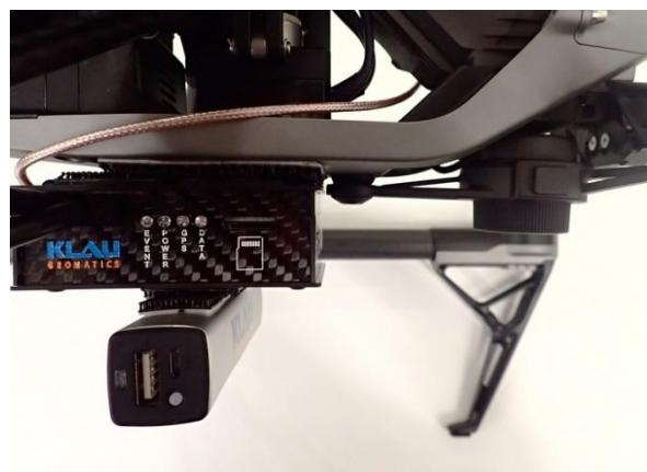
写真5 ユニットボックスおよびモバイルバッテリーの取り付けイメージ
