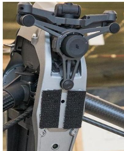
写真3 機体下部にマジックテープを貼り付けた様子
