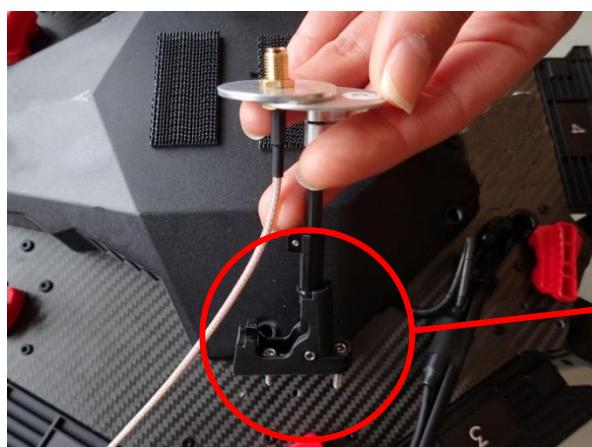
写真 9 アンテナ土台取り付けイメージ
